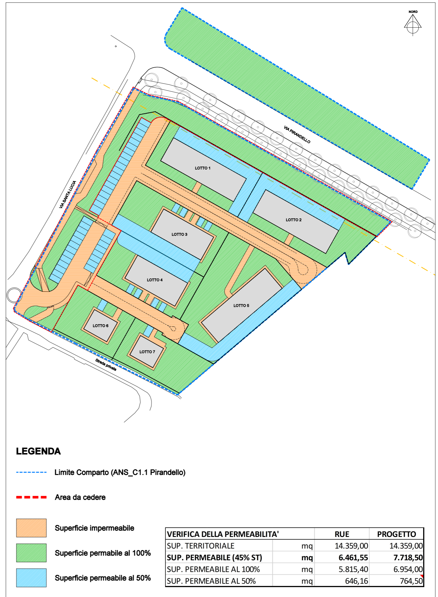
VERIFICA DELLA PERMEABILITA' - SCALA 1:1.000
